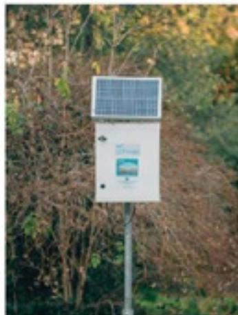
La sonda Finapp usa la tecnologia CRNS per misurare l'umidità del suolo e la SWE.
