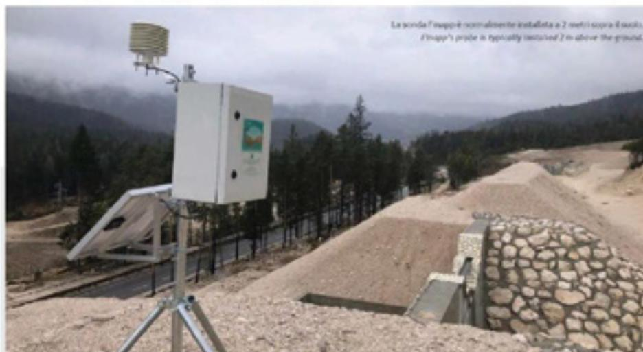
La sonda Finapp è normalmente installata a 2 metri sopra il suolo.
